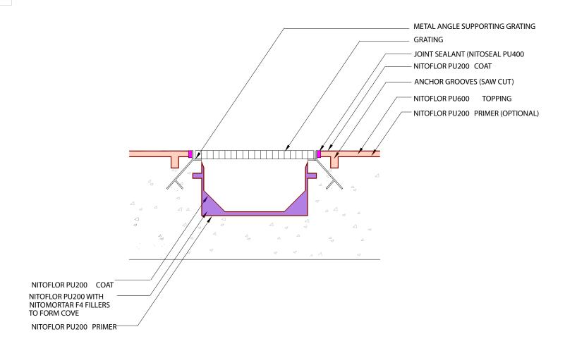
TYPICAL DRAINAGE DETAIL - NITOFLOR PU600 (METAL ANGLE SUPPORT GRATING)
