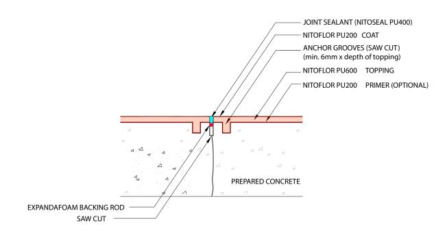
TYPICAL NITOFLOR PU600 SAW CUT CONSTRUCTION JOINT SCALE:- NTS
