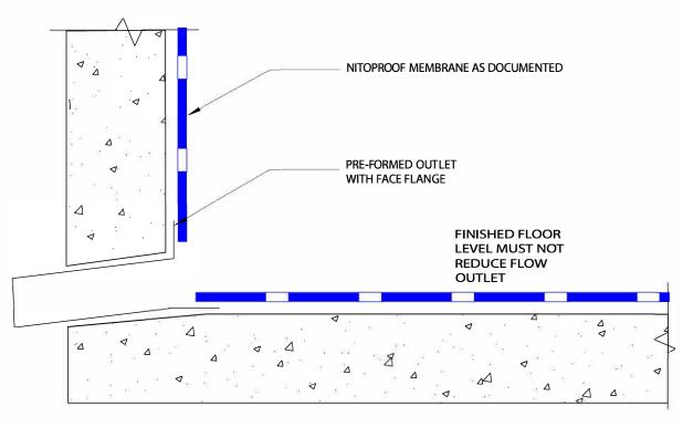
NOTE: THE OVERFLOW PIPE SHOULD BE LOCATED IN A REASONABLY VISIBLE LOCATION TO ALERT OF A POTENTIAL BLOCKAGE. IT SHOULD ALSO BE THE SAME DIAMETER AS THE DRAINAGE ON THE DECK
