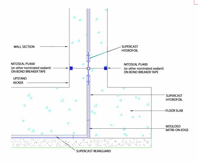
SUPERCAST - TYPICAL FLOOR KICKER TO WALL WATERSTOP DETAIL
